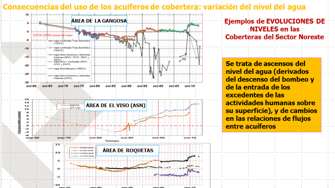
Figura 9: Evolución del nivel del agua (msnm) en acuíferos de cobertera. Superior: ASC (área de Las Norias y de Onáyar). Inferior: coberteras del Sector Noreste: áreas de La Gangosa, El Viso y de Roquetas.
